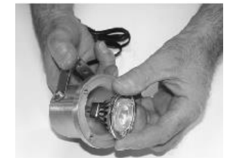
LED-Leuchtmittel entnehmen (dazu mit einem flachen Schraubenzieher seit- lich vorsichtig abheben) und dann das neue LED-Leuchtmittel in die beiden Kontakte einstecken. Glasscheibe mit Dichtungsring einlegen. Abdeckung korrekt aufsetzen und mit Schrauben wieder sichern.
