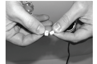
Steckverbindung lösen und neue LED-Einheit aufstecken
